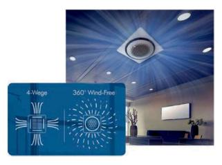
Im Gegensatz zu 4-Wege-Deckenkassetten mit Lamellensteuerung tritt die Luft aus den Wind-Free™ 360° Kassetten gleichmaßig und ohne Lamellenbewegung in einem Radius von 360° aus. Der Luftaustrittswinkel ist fur drei 120° Zonen von horizontal bis vertikal einstellbar.
